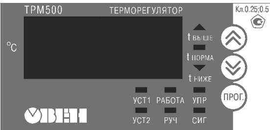
нагрев, о чем свидетельствует индикация «РАБОТА» на каждом терморегуляторе. Индикация «УПР» показывает работу ТЭНов.
