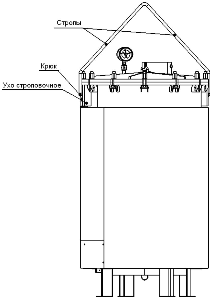
Рисунок 10. Схема строповки
