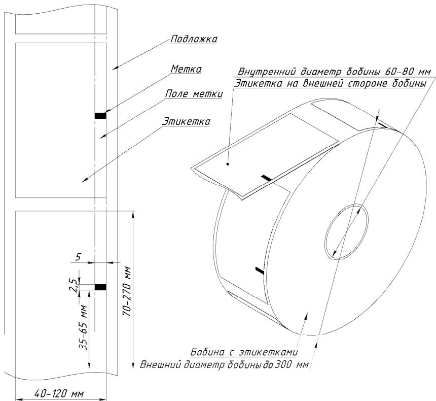
Рисунок 2. Рекомендуемые размеры и расположение метки на этикетке.
