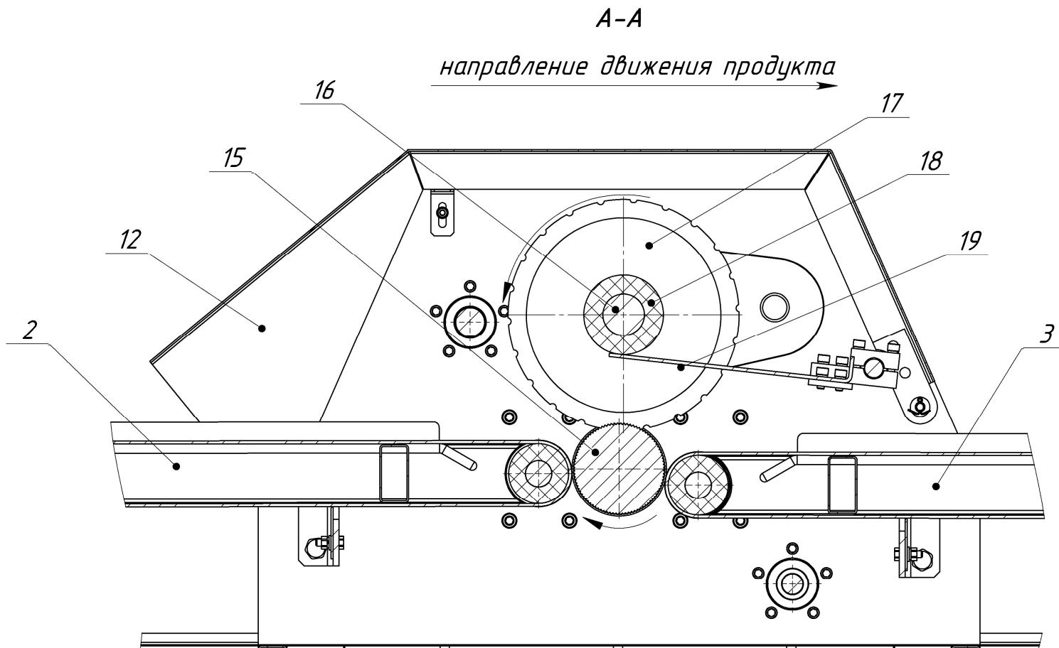
Рисунок 1, б. Устройство нарезки ИПКС-074-01-200Ч(Н)
