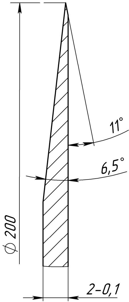
Рисунок 3. Заточка режущего ножа
