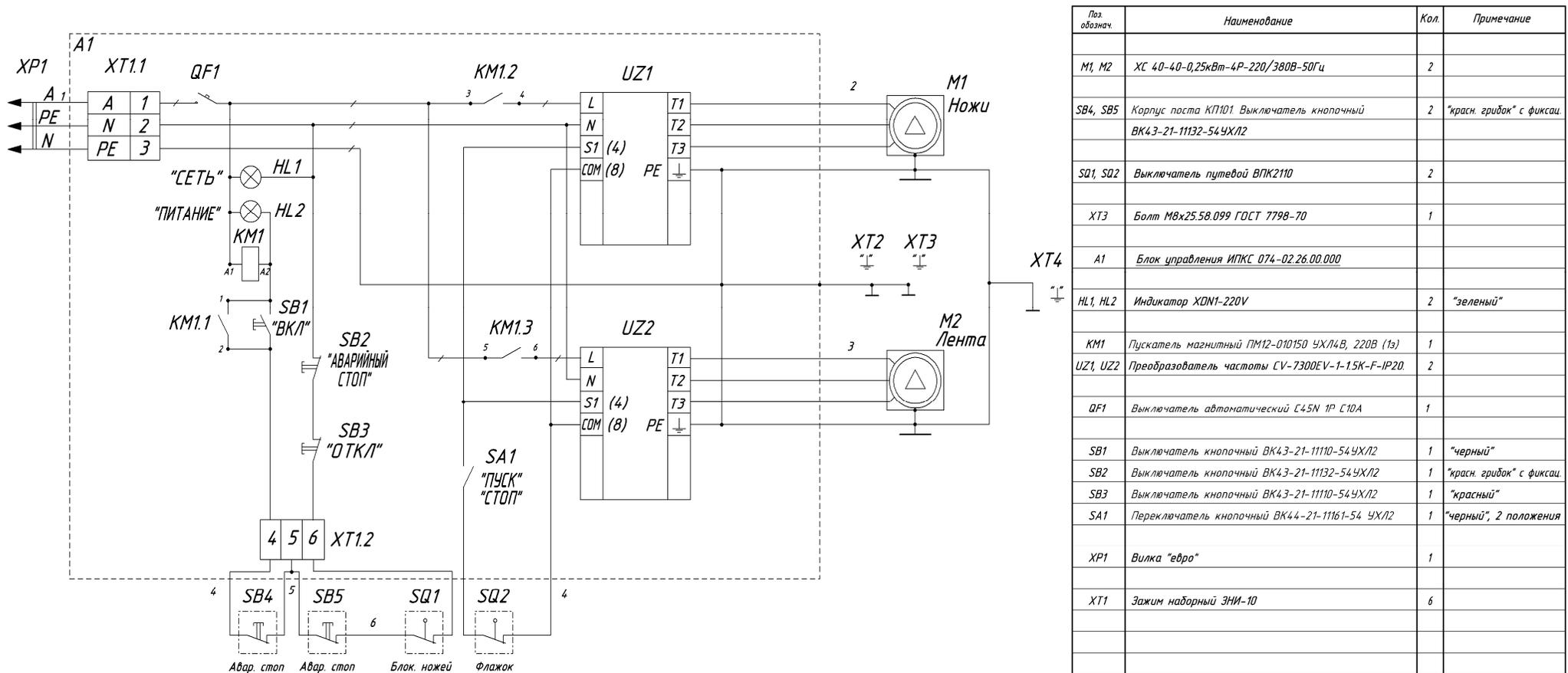
Рисунок 3. Устройство нарезки ИПКС-074-140С(Н).
