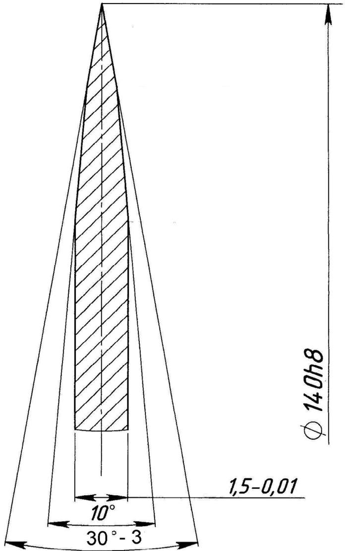
Рисунок 2. Заточка режущего диска
