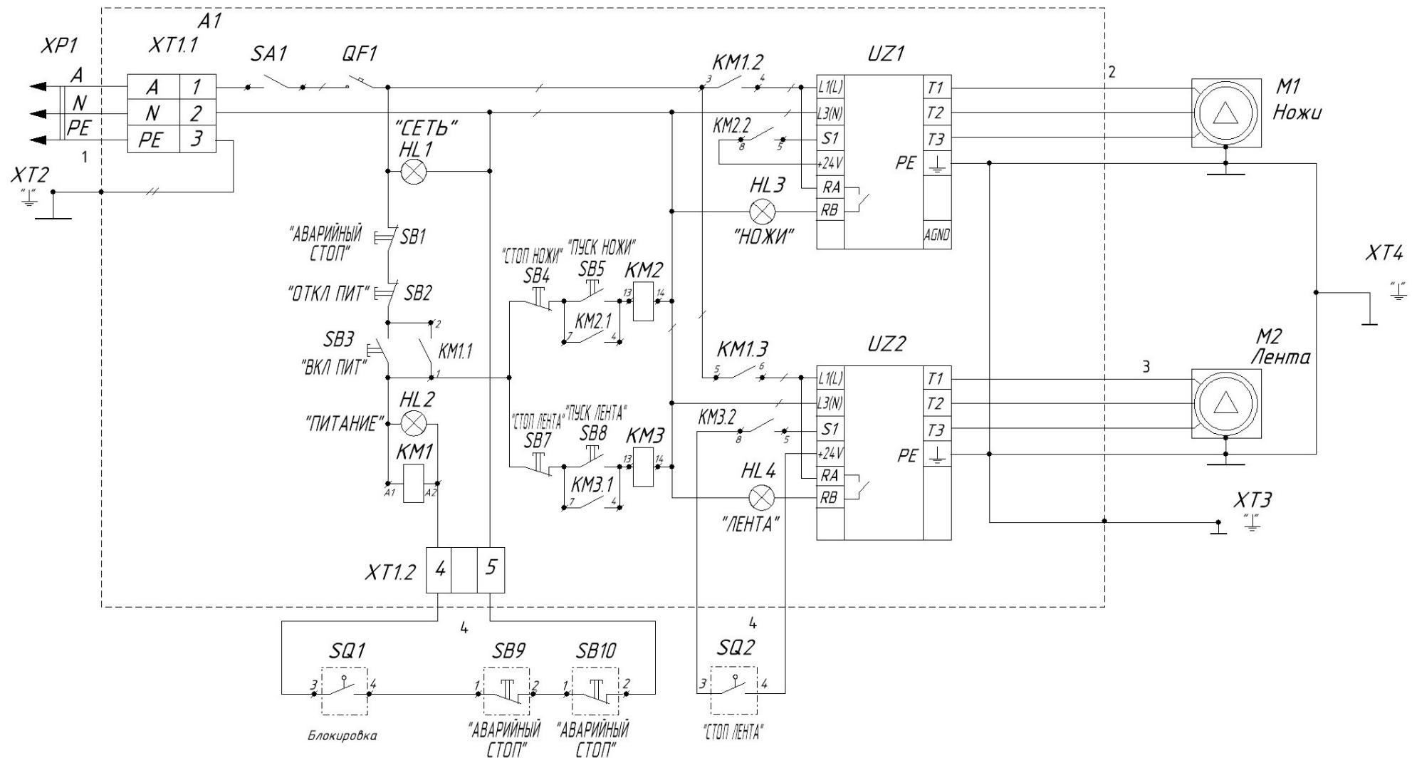
Рисунок 3. Устройство нарезки ИПКС-074-01-125Ч(Н).
