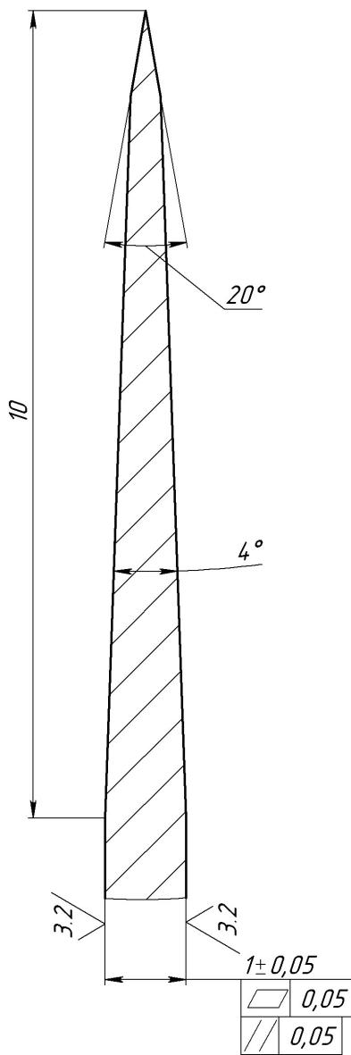
Рисунок 2. Заточка режущего диска
