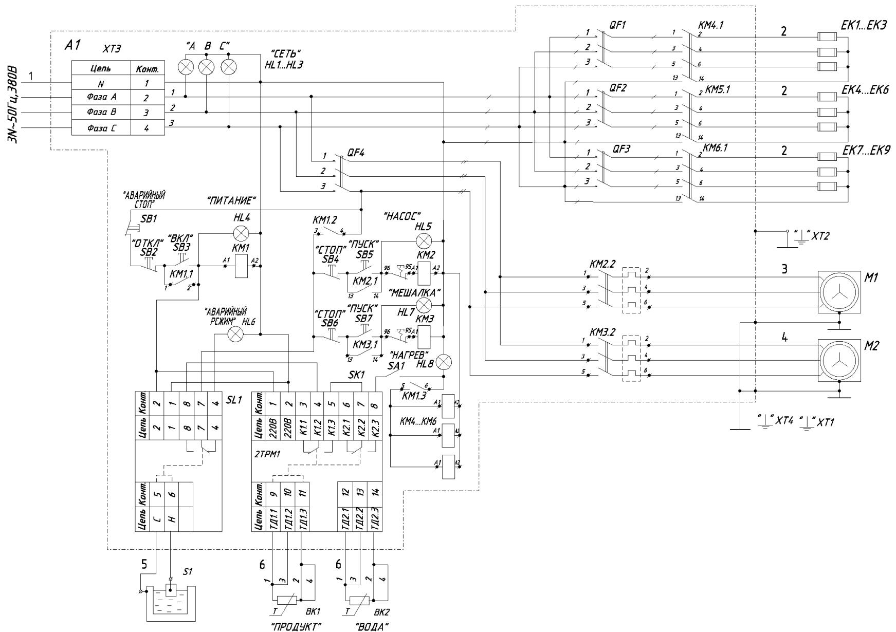
Рисунок 6. Модуль технологический универсальный ИПКС-056-03(Н).
