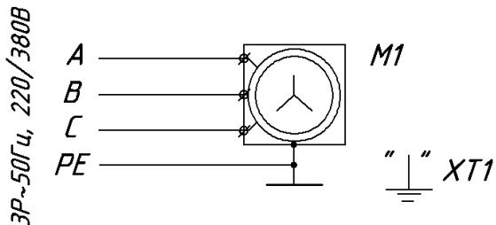
*M1* - мотор-редуктор *ХС-40-40-0,25кВт-220/380В-50Гц*
