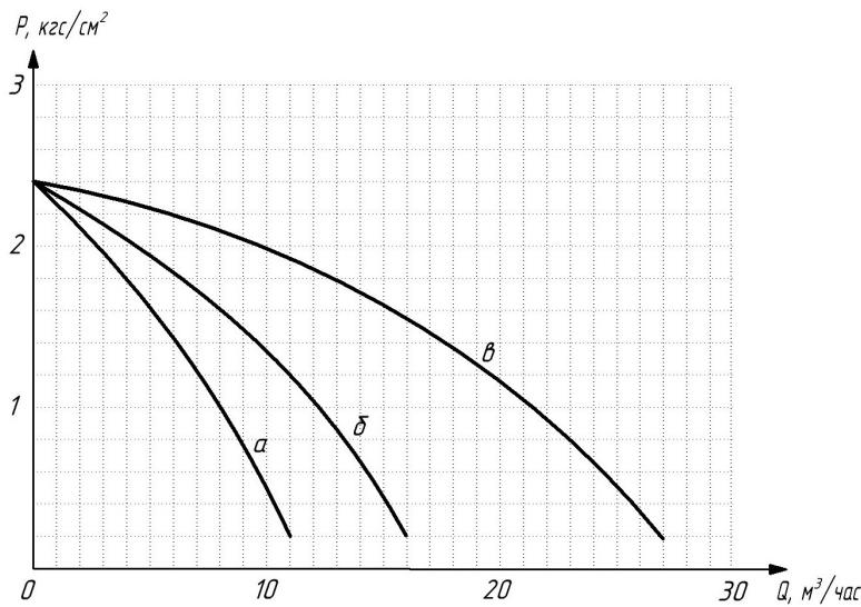
Рисунок 3. Рабочая характеристика насоса центробежного:
